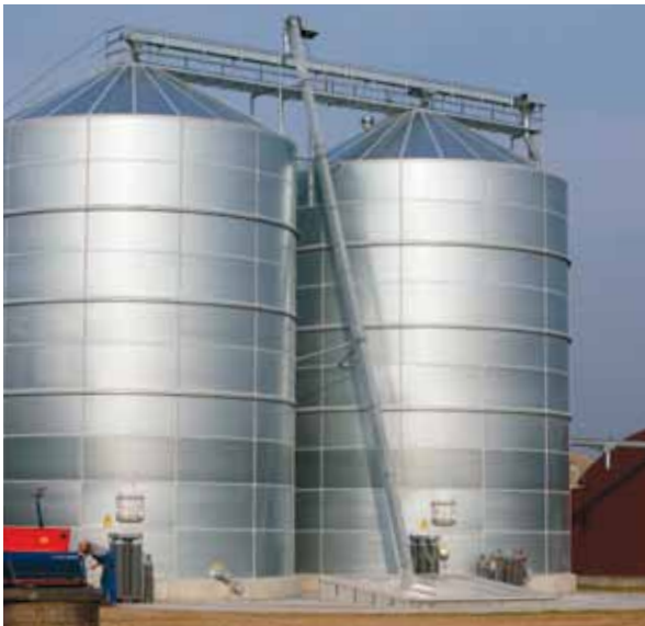
Zwei 930/10 (total 1732 M3). 40 T Transport mit Grube, Kettenelevator und Laufsteg mit umschaltbarem Förderer.
