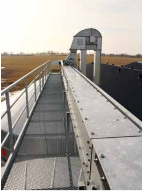
Vilja nostetaan Arven sikatilalla ylös siiloihin elevaattorilla, josta tasokuljetin siirtää sen haluttuun siiloon.
