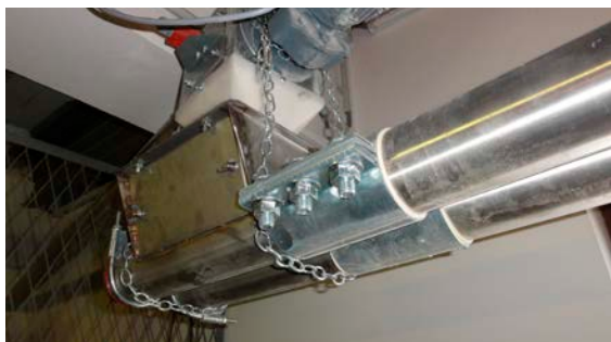
Transport snegl i rustfrit stål.
